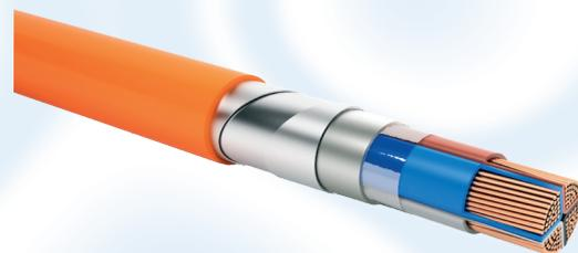
Кабель силовой с многопроволочными жилами секторной формы, в броне из оцинкованных лент, с оболочкой «ЗГ» - стойкой к грызунам, муравьям и термитам
